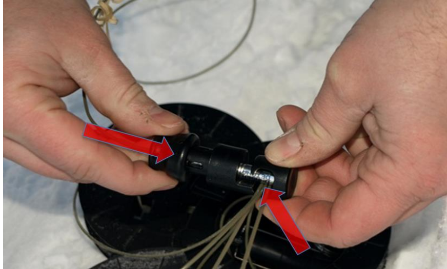
Joonis 3. Detonaatori ja süütelinide ühendamise adapteriga
